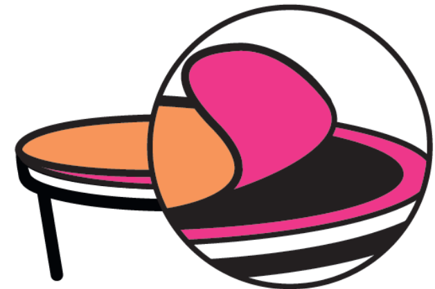
Opercule pelable Pelabilité cohésive
